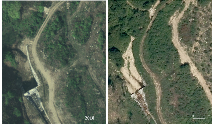
그림 10. 충주시 지역의 토석류에 의한 사방댐의 매몰
